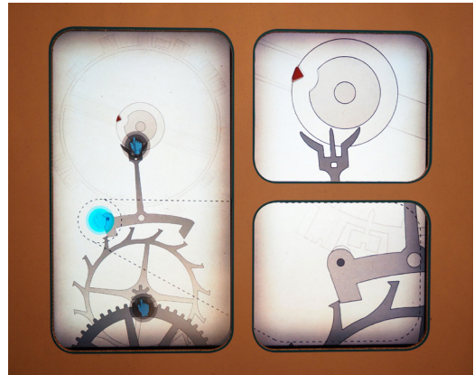
Fig. 5. Glashütte lever escapement.
